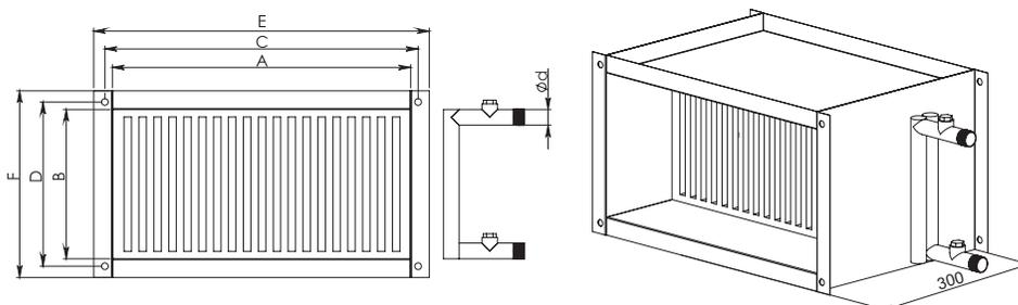
Используется в системах вентиляции. SVS воздушонагреватели изготовлены из медных трубок и алюминиевых пластин. Корпус изготовлен из оцинкованной стали. Нагреватели и охладители можно подобрать в соответствии с имеющимися параметрами, используя программу подбора, которую можно найти на интернет-сайте [www.salda.it](http://www.salda.it)
