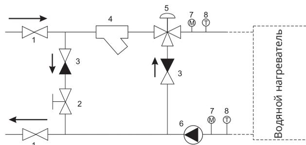
Основной функцией точки смешения является контроль, совместно с системой управления, температура подаваемой воды в водонагревателях. Используется для контроля воды температуры в обогревателях, воздушных завес и т.д. точкой смешения используется наряду с другими устройствами (закрывающей заслонками, датчик температуры, системы управления) с целью защиты нагревателей от замерзания.
