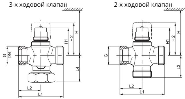
Используется в системах вентиляции для регулирования температуры подаваемой воды в водонагревателях. Для фанкойлов, небольших повторных нагревателей и небольших повторных охладителей.
