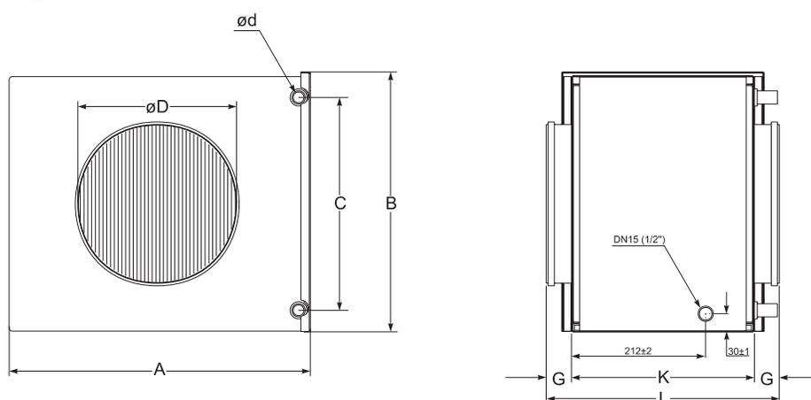
Канальные охладители используются в системах вентиляции, требующих поступления охлаждённого воздуха. Охладители AVA изготовлены из медных трубок и алюминиевых пластин. Корпус изготовлен из оцинкованной жести. Имеется система дренажа конденсата.
