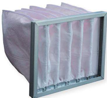
Прямоугольные карманные фильтры используются для очистки воздуха. Они устанавливаются в корпус фильтров. Материал может быть различного класса очистки: G4, M5 или F7. Рамка фильтров изготавливается из оцинкованного железа и имеет ширину 25 мм.
