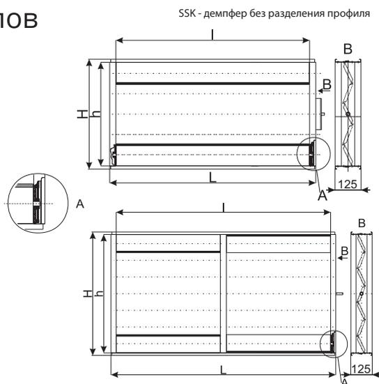
Заслонки для SSK регулировки воздушного потока. Заслонки изготовлены из алюминиевых профилей, алюминиевых лопаток с резиновым уплотнителем. Управляющий механизм лопаток изготовлен из стекловолокна. Герметизирующий материал обеспечивает необходимую герметичность заслонок. Заслонки пригодны к эксплуатации в температурном диапазоне от -40°C до +80°C.
